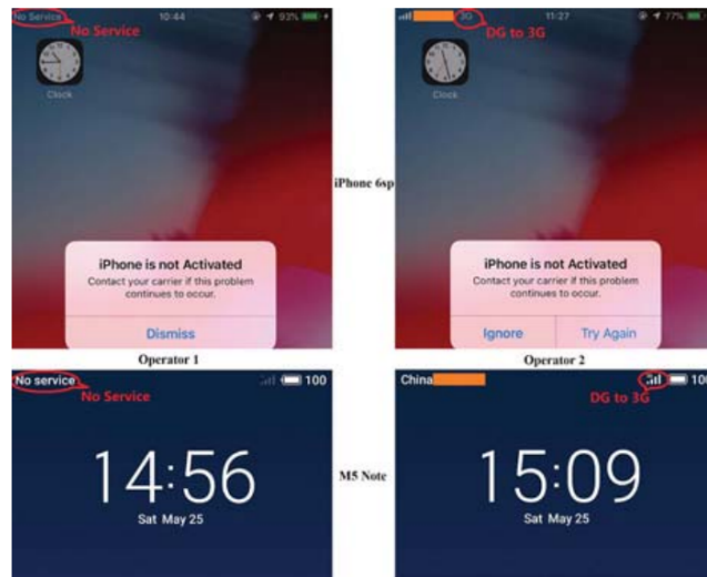
Figura 6.8: La reazione dell'UE di due diversi operatori a un Authentication Reject.
