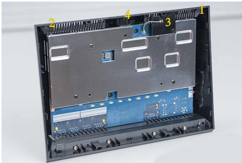
Figura 6.1: Vista frontale della board del Router Asus rt-ac86u con indicate le quattro radio chain, di cui una interna
