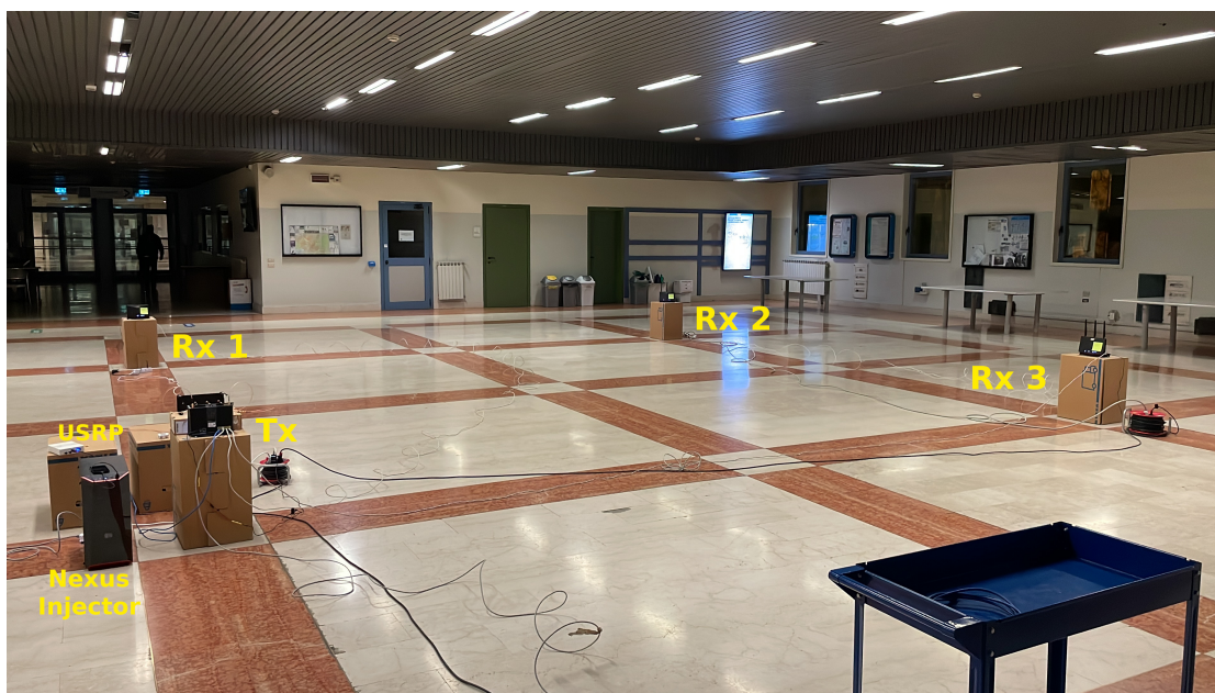
Figura 6.15: Fotografia con la disposizione a forma di quadrato dei quattro router usata nell'esperimento in campo aperto, nell'atrio dell'Università degli studi di Brescia. A fianco del Beamformer Tx è possibile notare anche il Nexus 5 utilizzato come Iniettore, collegato a un computer desktop tramite l'interfaccia ADB e l'USRП utilizzata per misurare le fasi di ciascuna antenna.
